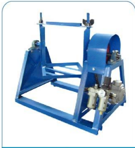
TG-Q30-B 配活塞式气动马达 Piston-type pneumatic motor
